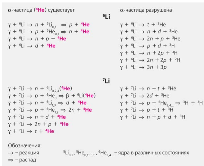
Рис.5. Две группы реакций фоторасщепления двух изотопов лития по отношению к присутствию среди продуктов \alpha -частицы (ядра {}^4\text{He} ).
